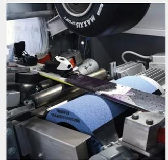
Um Ski zu schleifen, bietet Reichmann & Sohn Schleifautomaten in unterschiedlicher Größe an. Die Bearbeitung klingt einfach: Zunächst wird der Ski vermessen, dann wird er geführt eingezogen und zum Schleifen über einen rotierenden Stein geführt. Am anderen Ende der Maschine wird der Ski entnommen oder automatisch in ein Lager abgelegt. Die Herausforderung liegt aber darin, auf die Ski hochwertige Strukturen aufzubringen und dabei die Maschinen möglichst einfach regeln und bedienen zu können.
